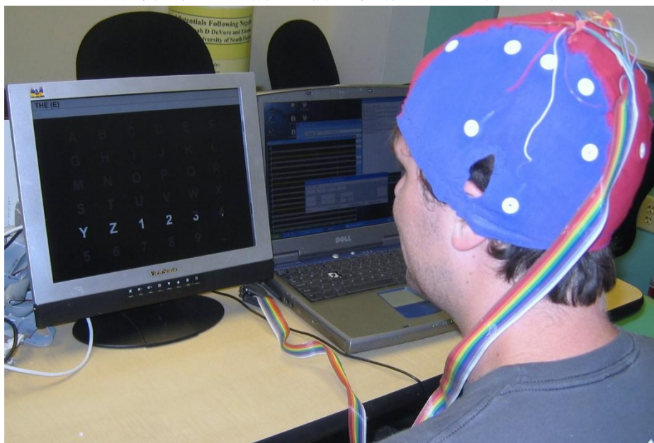
图二：配合 P300 拼写器的脑电采集系统实景
