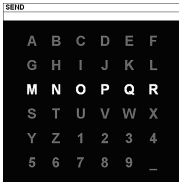
图一: Farwell 博士和 Donchin 博士设计的 P300 拼写器。图中的行与列会随机闪烁, 包含有目标字母的行或列闪烁时会经由 oddball 机制激发 P300 脑电反应。
